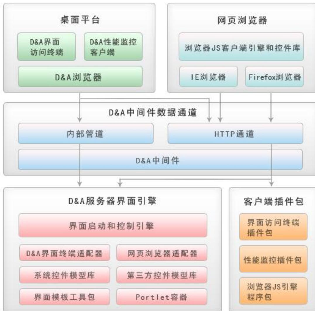
图：界面框架架构图
